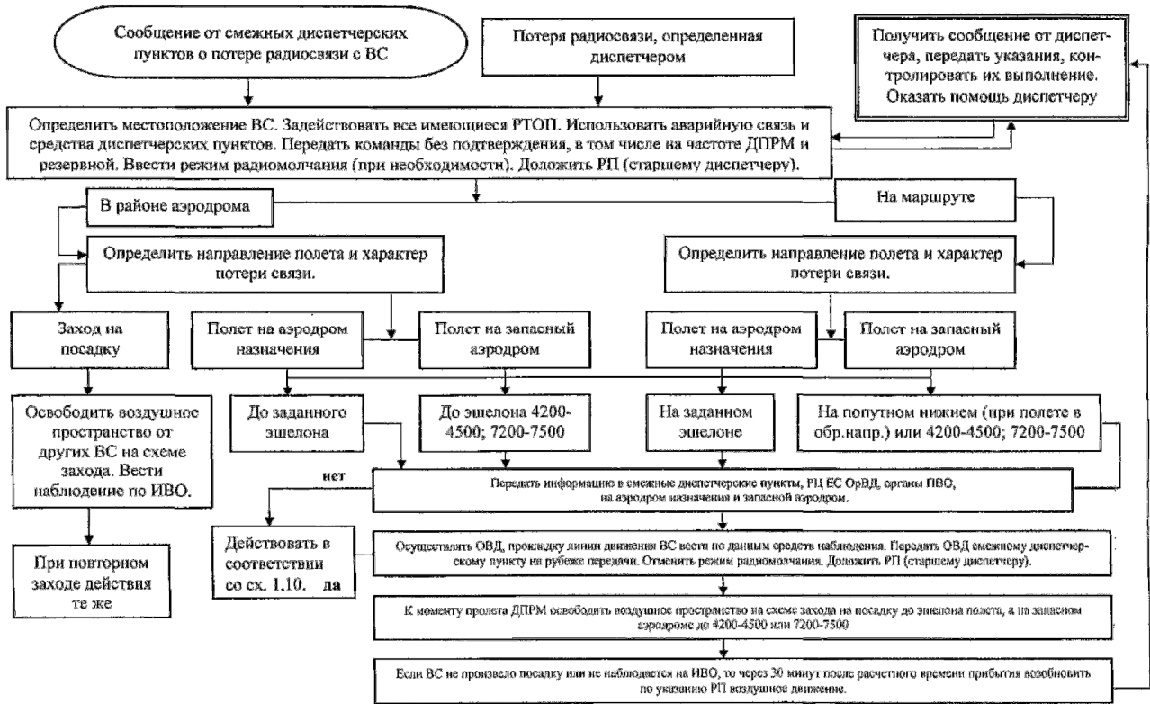
Схема 1.5. Действия диспетчеров органов обслуживания воздушного движения (управления полетами) при потере радиосвязи.
